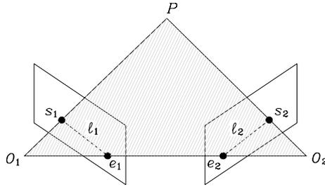
Fig. 10.10. Epipolar geometry
