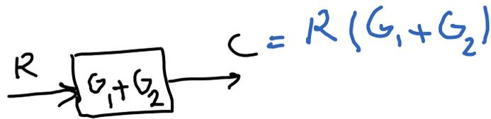
Transfer Function بلوک تابع تبدیل block
