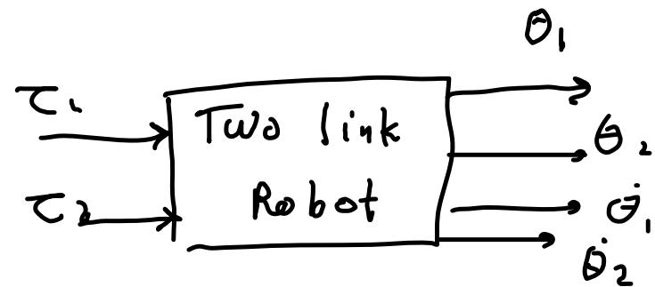
$$T_a \rightarrow [m(q) \ddot{q} + V(q, \dot{q}) + G(q) = T - D\dot{q}] \rightarrow q$$
